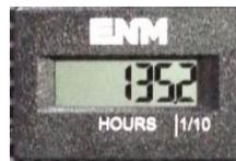
Der Generatorenölstand muss alle acht (8) Betriebsstunden kontrolliert werden.
