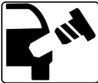
Falls sich die Benzindeckelleuchte einschaltet, sollte der Benzindeckel entfernt und erneut festgemacht werden. Eine Weiterfahrt ist problemlos möglich. Der Computer wird einige Tage benötigen, bevor er die Leuchte löscht.
