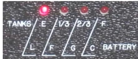
2. Benzin- und Propantanks müssen **VOLL** sein (Kontrollieren Sie die Tankanzeigen!)
