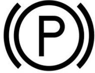
Als gute Praxis für alle Automatikgetriebe – betätigen Sie die Feststellbremse (1) immer bevor Sie das Getriebe in 'Park' schalten.
