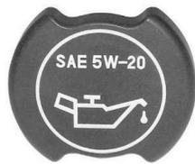
Die Motorenölqualität ist 5W-20. Der Motorenölstand muss alle 500 gefahrenen Meilen kontrolliert werden, der Ölstand des Generators alle acht (8) Betriebsstunden.
