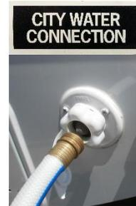
Maximal erlaubter Wasserdruck: 45 PSI / 3.1 bar
